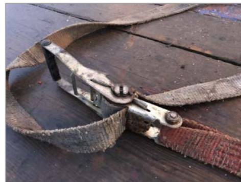
Starke Ratschen-Korrosion, verschlissenes Gurtband
