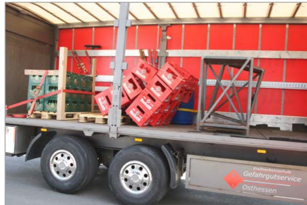
Massenkräfte im Fahrbetrieb führen zum Verrutschen und Kippen der Ladung
